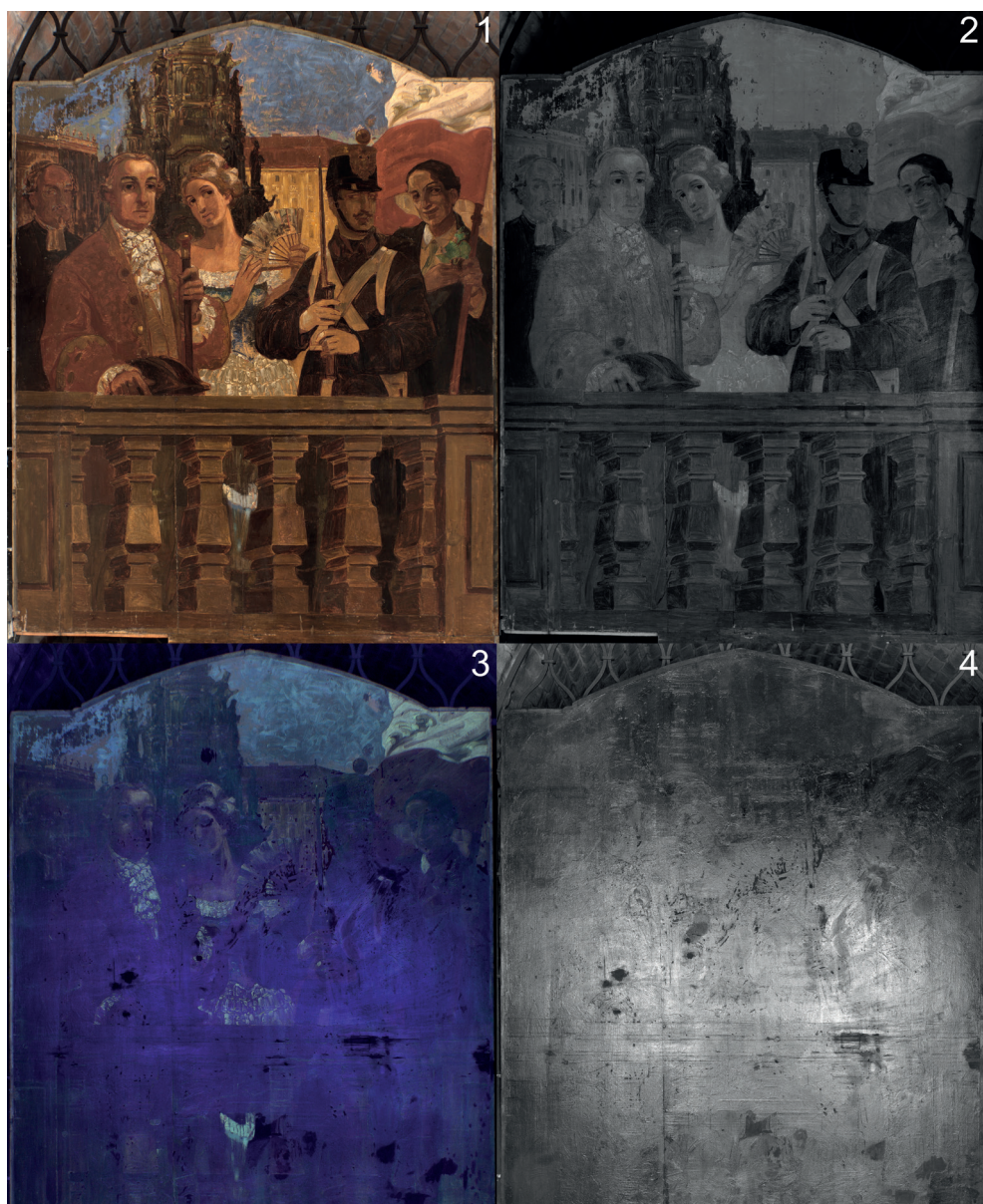
Obr. 4: Výstupy multispektrálního snímání Měšťané na Hané. 1) viditelná oblast; 2) IČ reflektografie; 3) UV excitovaná viditelná luminescence; 4) UV reflektografie.
