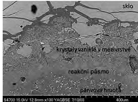
Obr. 16. Dokumentace výsledku interakce skloviny s hmotou pánve na nábrusu vzorku; dole na snímku je pánvová hmota, středová část – krystaly vzniklé v mezivrstvě mezi sklovinou a materiálem pánve, šedé plochy v horní části snímku – sklo. Fig. 16. Documentation of the interaction of the molten glass with the material on the polished section of the sample; at the bottom of the photo is the pot material, the middle part – crystals formed in the interlayer between the molten glass and the pot material, the grey area in the upper part of the photo – glass.
