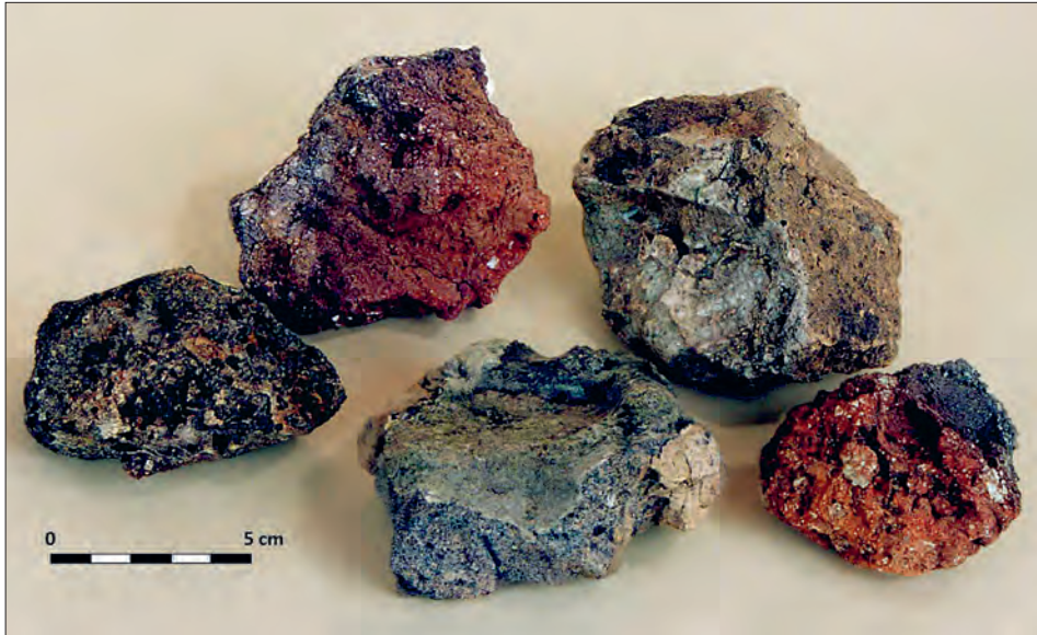
Obr. 5. Jilmová I. Spečené kusy vyzdívky stěn sklářských pecí (foto H. Sedláček). Fig. 5. Jilmová I. Pieces of fused lining of glassmaking furnaces.
