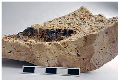
Obr. 12. Pánev s vrstvou silně zkorodovaného skla (př. č. 93/86-11). Povrch páneve je silně poškozen v důsledku působení skloviny při tavení skla.
