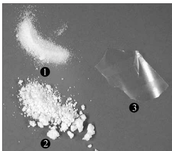
Obr. 3. Typy parylenu: 1. práškový dimer Parylen N, 2. práškový dimer Parylen C, 3. vrstva parylenu po polymeraci. — Fig. 3. Types of parylene: 1. Powder Dimer Parylene N, 2. Powder Dimer Parylene C, 3. Parylene Film after Polymerization.
